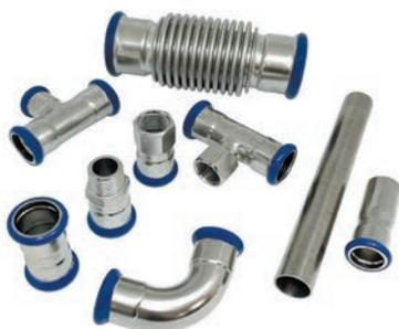
Трубы и фитинги Sanline Press из нержавеющей стали предназначены для транспортировки жидкости в системах горячего и холодного водоснабжения, высокотемпературного отопления и других инженерных системах с рабочей температурой теплоносителя до 120°C и номинальным давлением до 16 бар.
