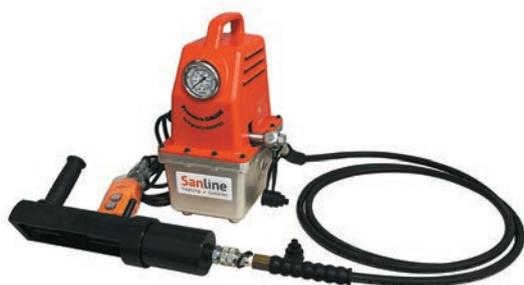
Электрический гидравлический пресс-инструмент предназначен для обжима нержавеющей пресс-фитингов Sanline профиля М диаметром от DN65 до DN100. Обжим фитинга осуществляется при помощи обжимных колец соответствующего диаметра и промежуточных клещей.
