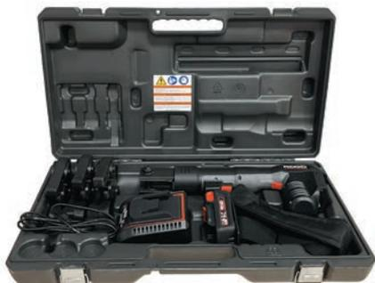
Аккумуляторный гидравлический пресс-инструмент RIDGID предназначен для обжима нержавеющей пресс-фитингов Sanline профиля М диаметром от DN12 до DN50. Обжим фитинга осуществляется при помощи обжимных губ соответствующего диаметра, для обжима труб диаметром DN40 и DN50 необходимо использовать промежуточные клещи-адаптер.
